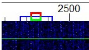
支持各种通讯模式，频谱图(绿色接收框)位置及(蓝色框)作为窄频带单独解码区域，当频率上非常多电台信息，可使用这功能，减轻电脑处理太多信息解码工作。
