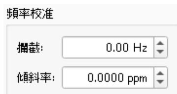
如果您使用 WWV 或其它可靠的频率参考校准您的电台，或者使用 WSPR 设置的精确频率测量中的技术，发送到电台并从其收到的频率值将被调整，使得由 JTDX 显示的频率是准确的。
